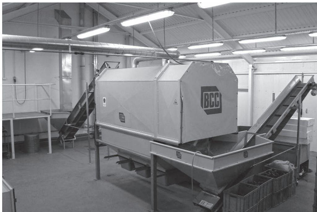
Rycina 3. Wyposażenie Karpackiego Banku Genów – wybijarka do szyszek (fot. G. Młynarczyk)
