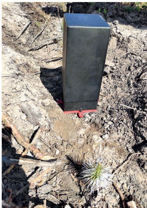
Rycina 3. Detektor SPOTTA do monitoringu szeliniaka - widok z osłoną (fot. T. Jabłoński)
