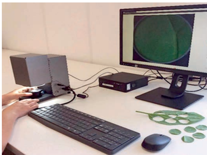
Rycina 5. Cirillo - urządzenie do zliczania owadów na liściach (fot. P. Korsten - Botany Group)
