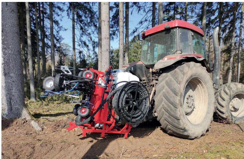
Rycina 8. Zestaw opryskiwacz + głowica operacyjna do zwalczania kornika drukarza przygotowana do transportu (fot. T. Jabłoński)
