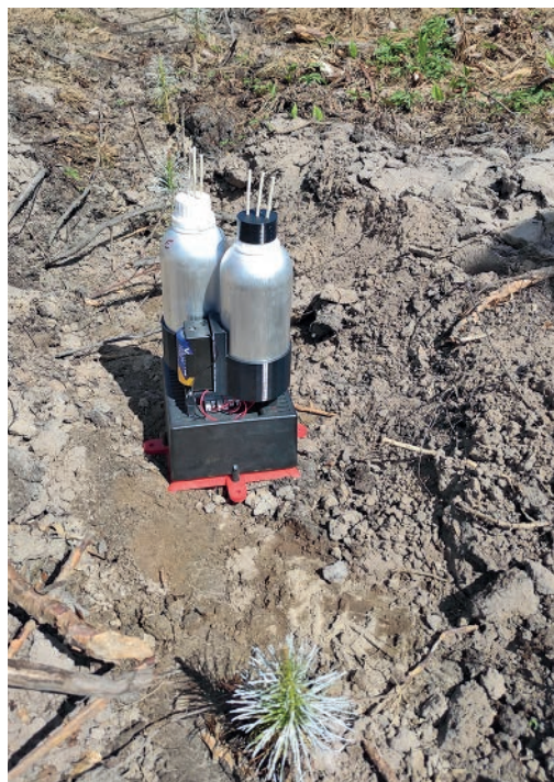
Rycina 4. Detektor SPOTTA do monitoringu szeliniaka - widok bez osłony z widocznymi pojemnikami z atraktantem (fot. T. Jabłoński)
